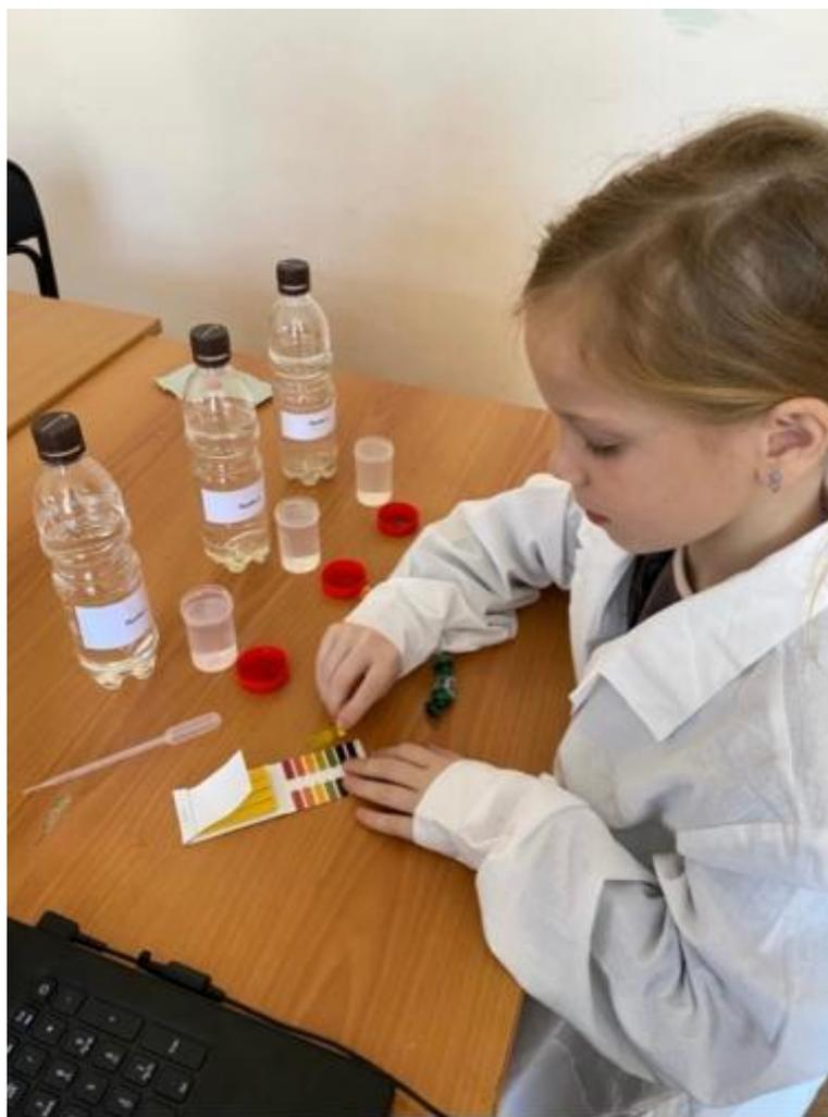
Рисунок 8 - Определение рН воды
