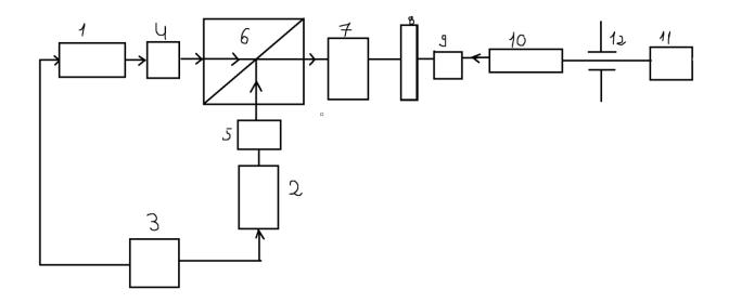
Рис. 1. Функциональная схема инфракрасного лазерного излучателя
