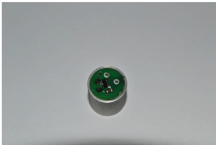
Рис. 7. Фотография лазерного диода с электронной платой
