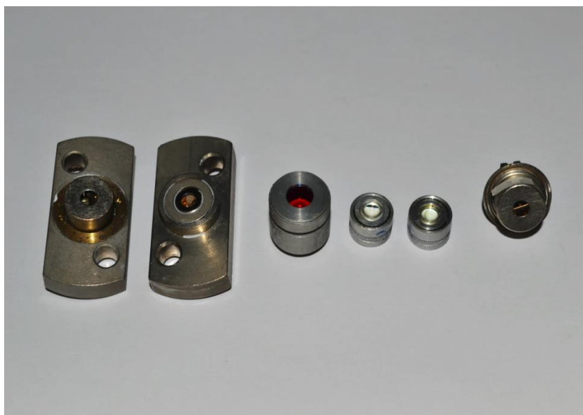
Рис. 5. Фотография комплектующих модуля накачки.
