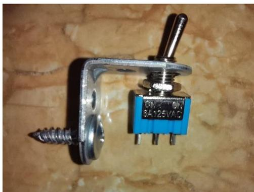
Рисунок 7.38 Подготовленный к монтажу выключатель питания
