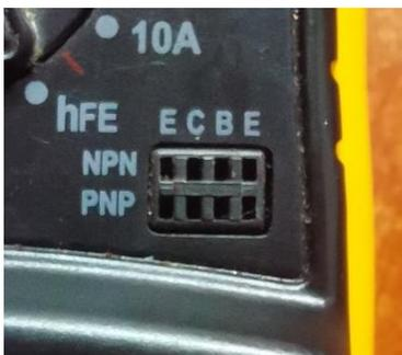
Рисунок 7.7 Гнезда для базы, эмиттера, коллектора
