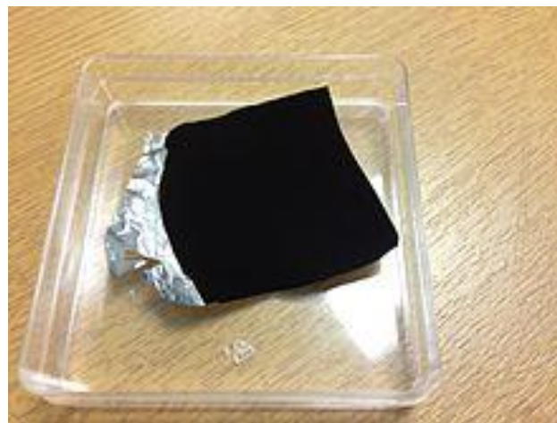
Рис. 7. Самый черный материал в мире Vantablack (краска), выращенный на металлической фольге
