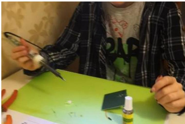
Процесс пайки – это нанесение расплавленного припоя на обработанные флюсом поверхности, флюс наносится с целью смачивания припоем паяемых поверхностей, смачивание требуется для получения при пайке металлургического соединения.
