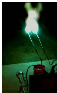
Рис.2.18. Стремление дуги вверх
