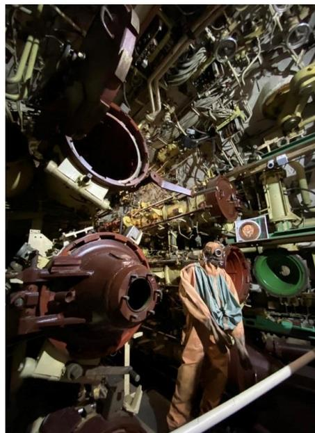
Рисунок 13. Торпедные аппараты подводной лодки
