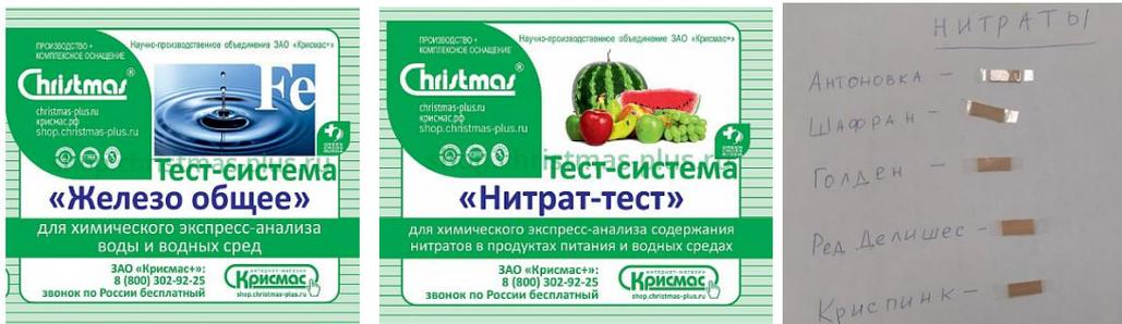
Рисунок 2. Тест комплекты для определения железа и нитратов.
