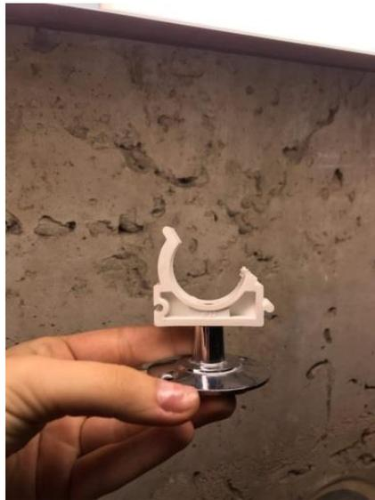
*Рис 2.11. Готовая подставка для двигателя.*
