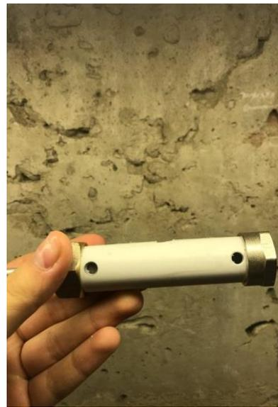
*Рис 2.3. Модель цилиндра из полипропиленовой трубы.*
