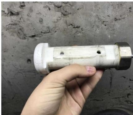
*Рис. 2.2. Готовый цилиндр, в котором ходит поршень*
