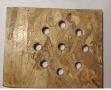
Рис.3.1.1 Выпиливаем отверстия в куске фанеры под магниты
