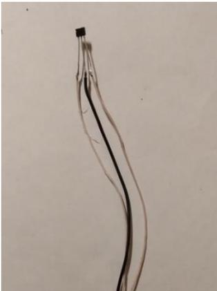
Рис.3.2.2 Припаиваем провода к датчику Холла
