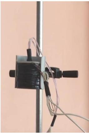
Рис.3.3.3 Вставляем датчик Холла в катушку
