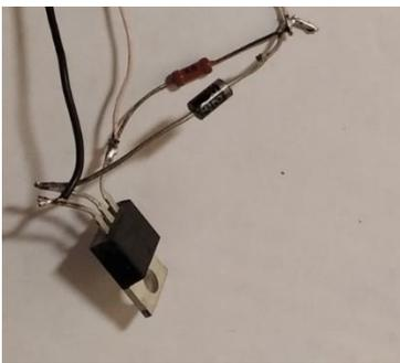
Рис.3.2.1 Припаиваем вместе резистор, диод и интегральный стабилизатор напряжения
