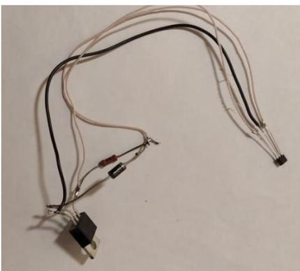
Рис.3.2.4 Припаиваем датчик Холла к подвесной схеме.
