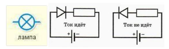
Работа светодиодной лампы зависит от полярности подключения источника тока. Светодиод работает только при прямом подключении источника тока.
