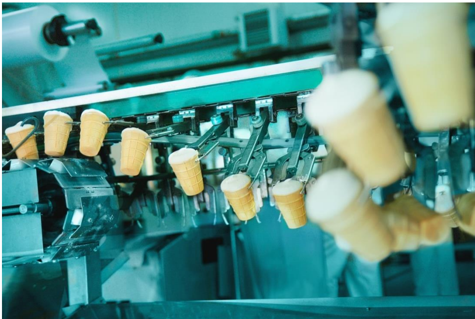
Рисунок 4. Заводская линия по производству мороженого пломбир в вафельных стаканчиках.
