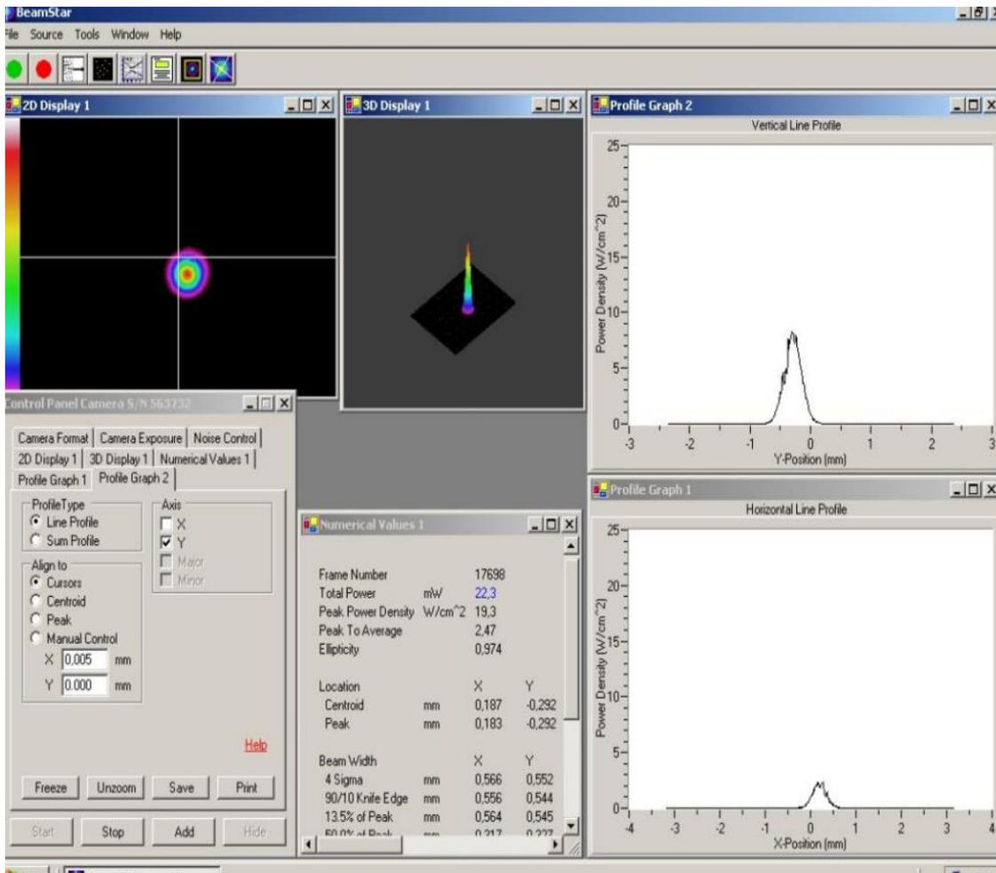
Рис. 4 Профиль лазерного пучка в фокусе метровой линзы.
