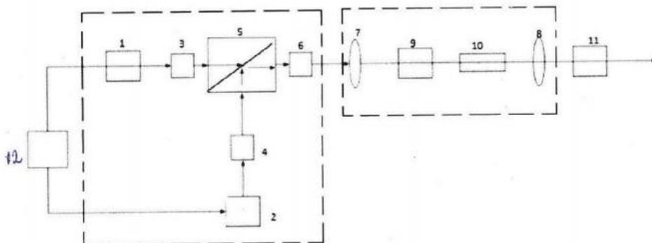
Рис.2 Функциональная схема лазерного излучателя с диодной накачкой.
