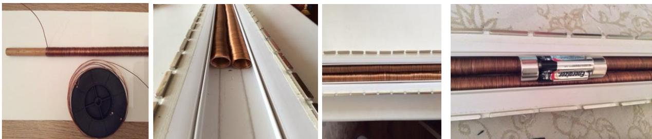
**Рельсы Дороги** из неодимовых магнитов клеим параллельно на боковые края платформы. Получаем Дорогу с углублением, в которой располагаются медные пружины, и «крылья» Дороги, по краю которой укреплены магнитные рельсы. Рельсы отводим от пружин для того, чтобы магнитные поля,
