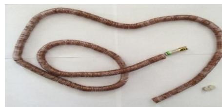
**Описание опыта.** Наматываем медный провод на стержень (диаметр 1,8 см), получаем пружину. Наматываем ровно, без зазоров между витками. К батарейке присоединяем с разных сторон два неодимовых магнита. Запускаем батарею с магнитами внутрь пружины.
