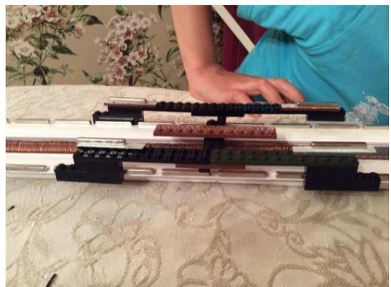
На двусторонний скотч крепим магнитные рельсы Платформы, используем прямоугольные магниты. В конструкцию Платформы добавляем стабилизирующий элемент – края Платформы опускаем ниже верхнего уровня Дороги, чтобы не соскакивала во время движения.
