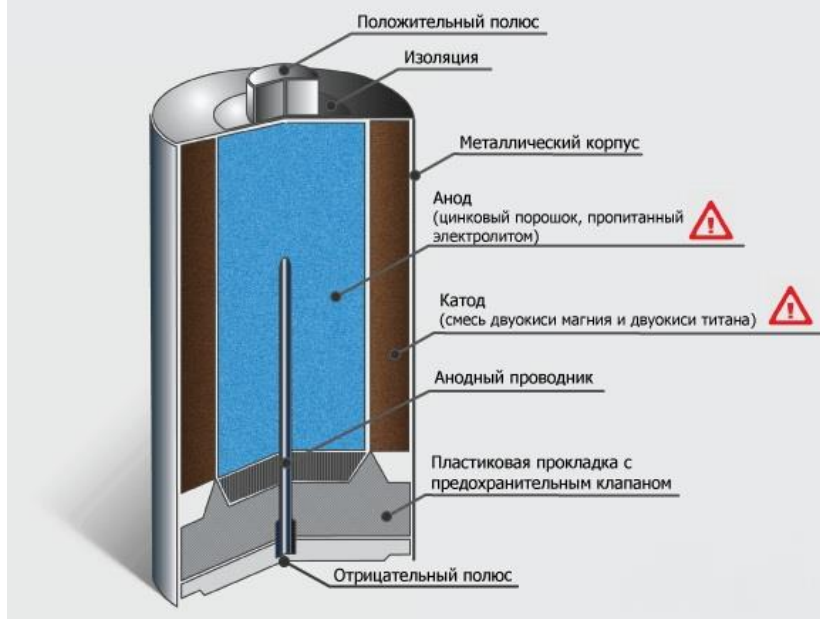
Рис. 1. Строение обычной батарейки
