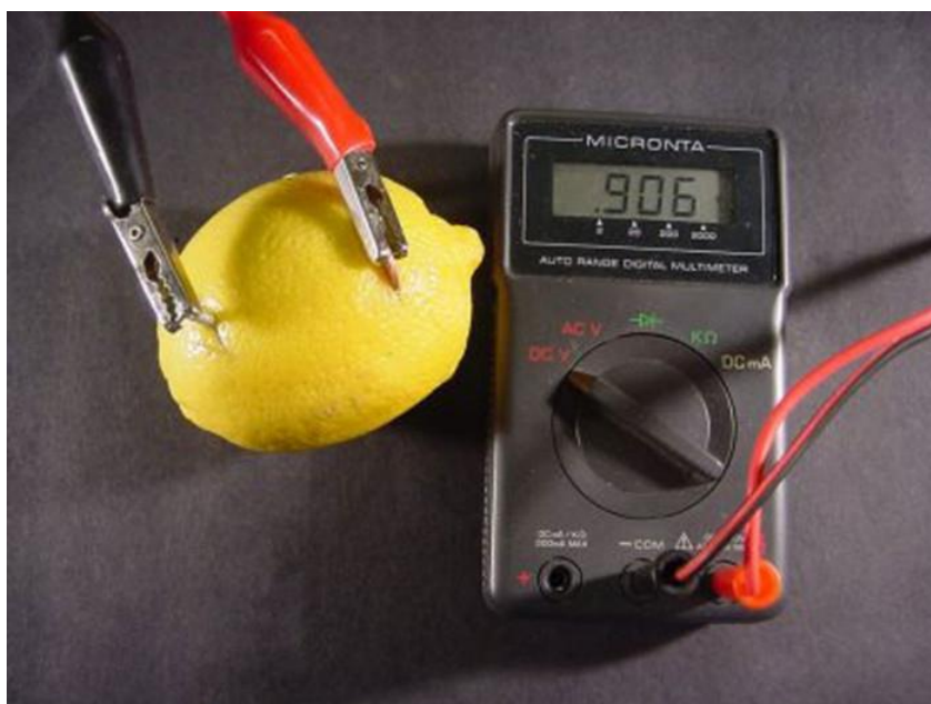
Рис. 3. Измерение напряжения лимона
