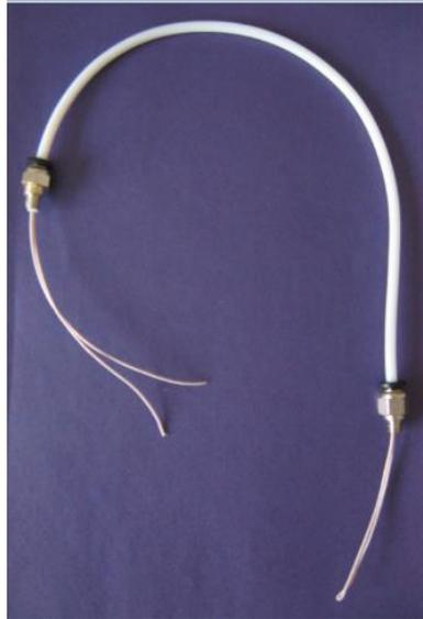
Рисунок 30 - Фторопластовая трубка с проводами и фитинги
