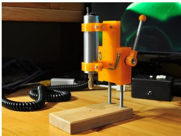
Рисунок 7 - Сверильный станок – Вариант 2
