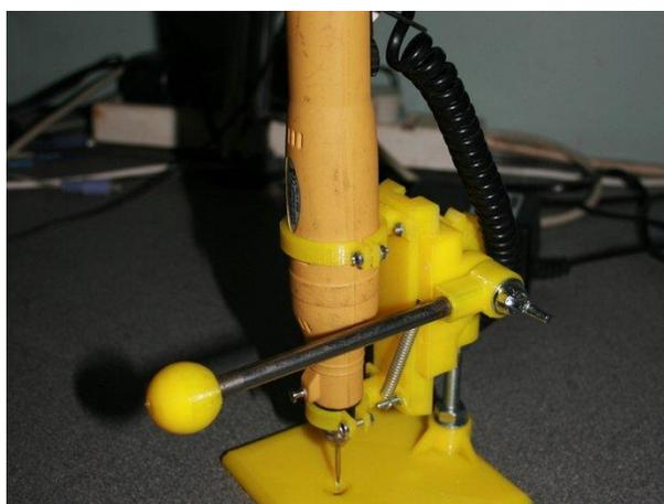
Рисунок 6 - Сверлильный станок – Вариант 1
