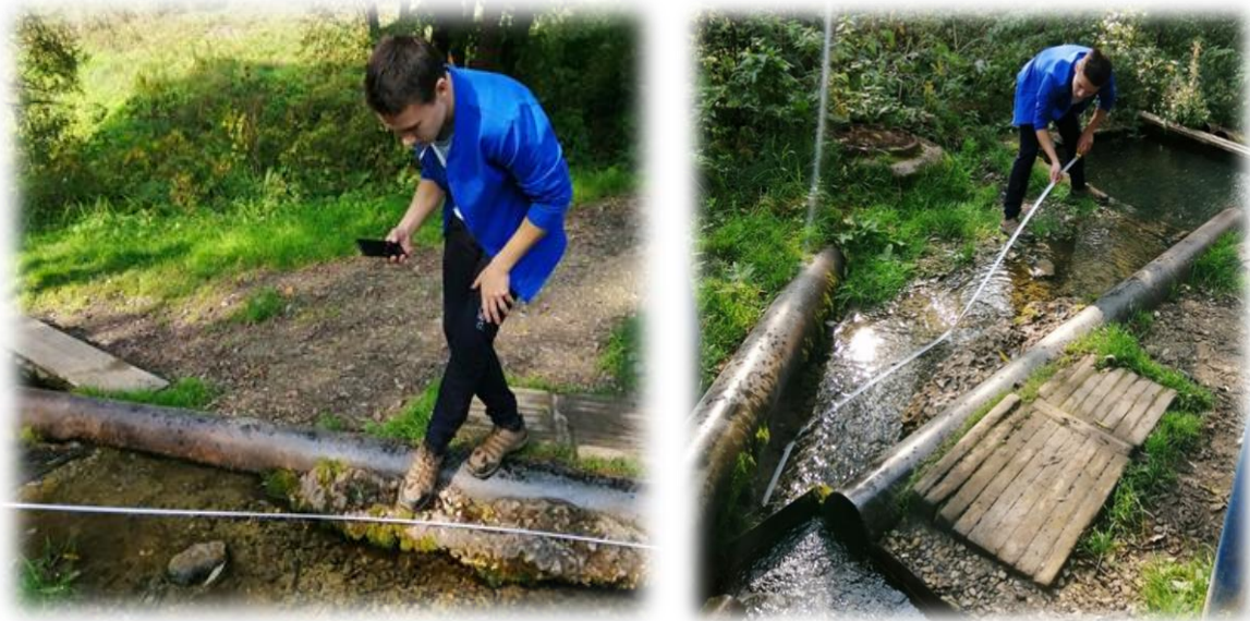
Определение дебита источника и температуры воды. 26 сентября 2020.
