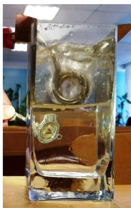
С целью устранения искажения, вызванные цилиндрической формой оптически неоднородной среды в химическом стакане с водой, применим прямоугольный стеклянный кювет с металлической перегородкой.
