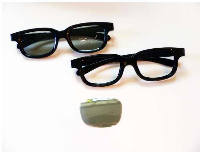
Рис.5. Пленку-поляроид из одноразовых очков из 3D-кинотеатра.
