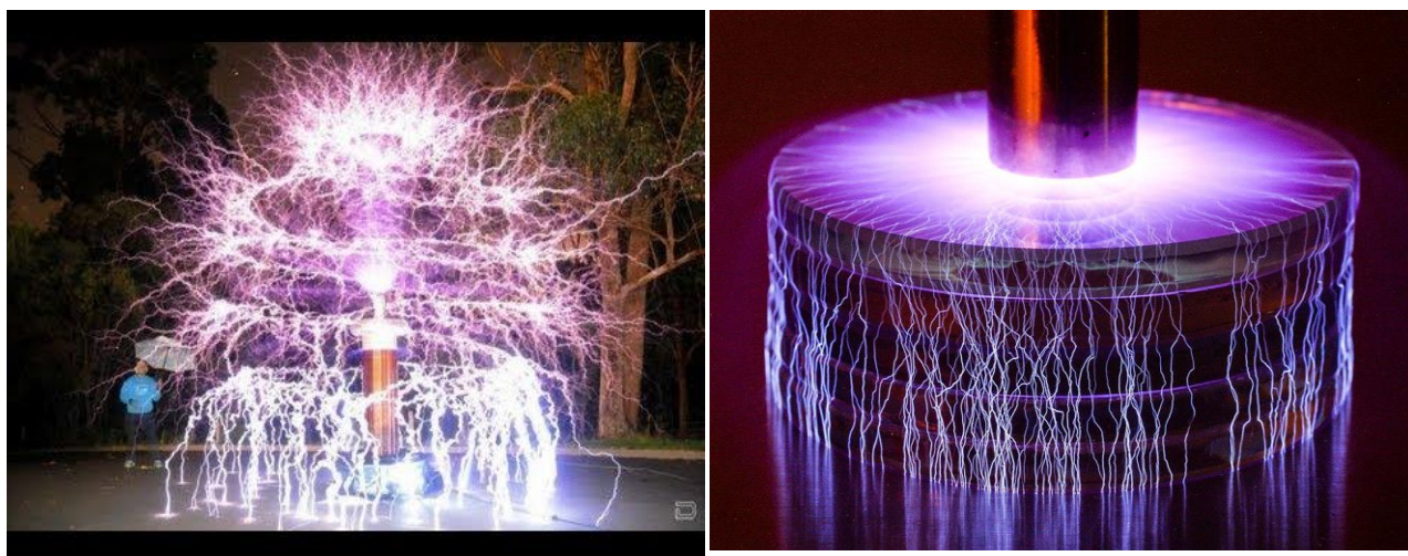
Рис. 18.3. Варианты разрядов трансформатора Тесла
