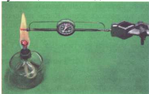
Рис. 2. Наблюдение магнитного действия термоэлектрического тока
