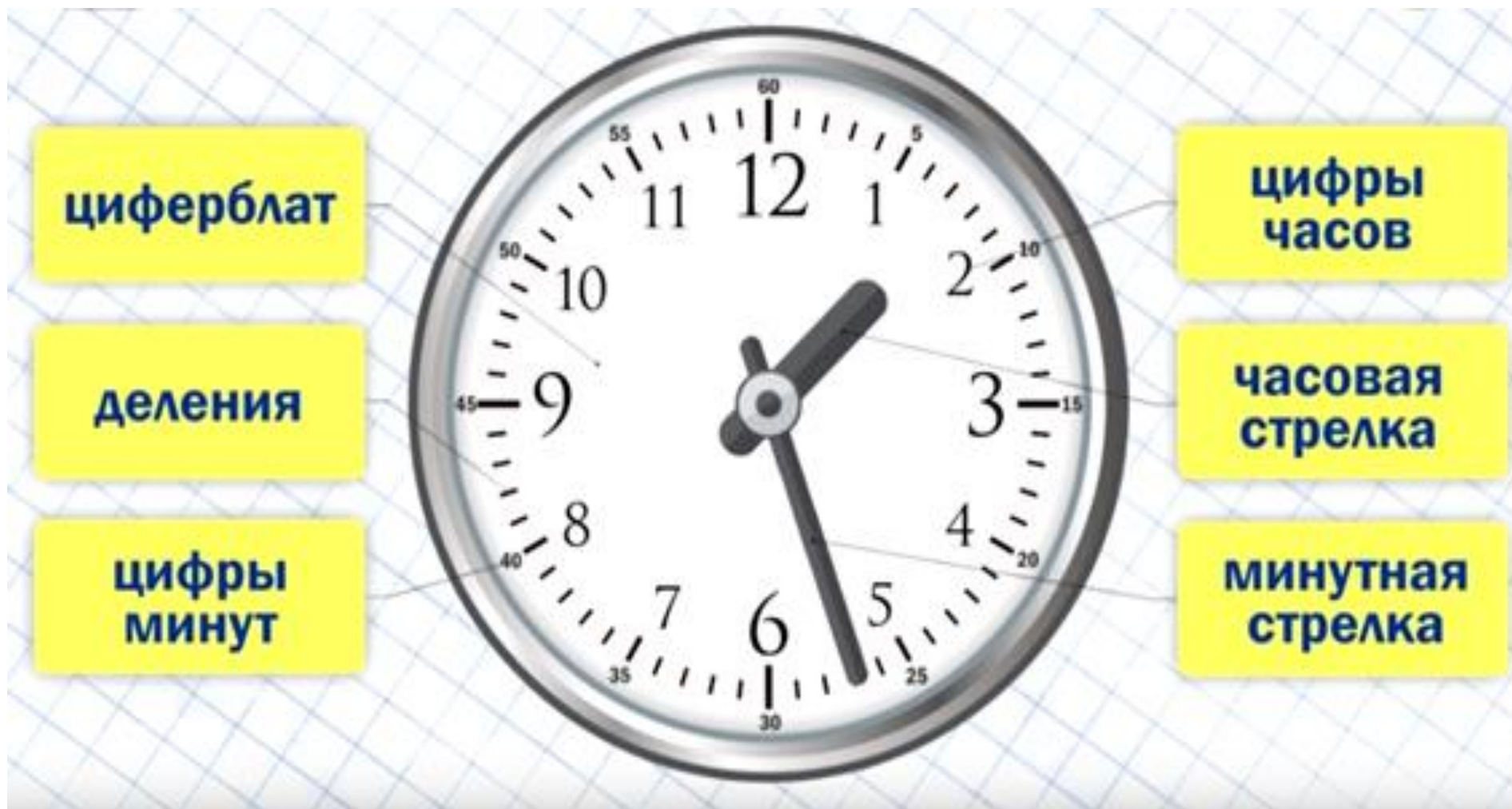
Приложение 7, рисунок 1. Строение часов.
